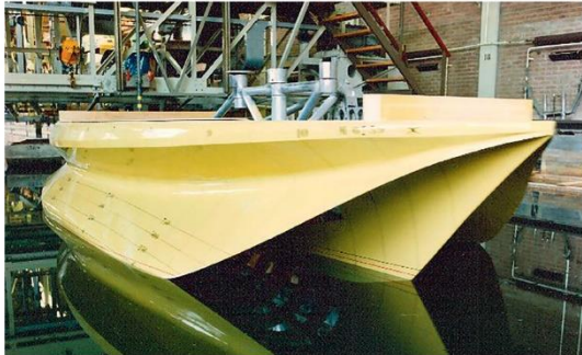
Escalade. Trimonoran gövdesinin havuzda testleri yapılırken.
